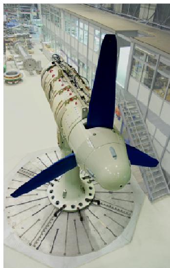
Voith HyTide tidal current turbine (1/3-scale prototype)
