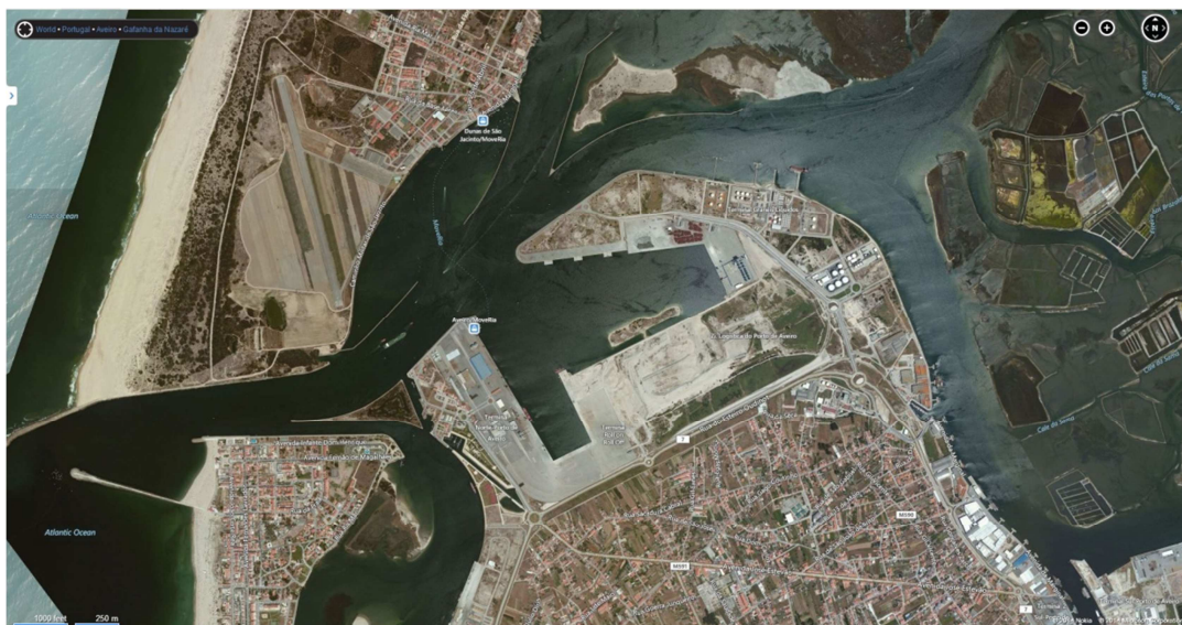
Figura 3.1 – Domínio de modelação CFD definido na área de estudo do porto de Aveiro, com uma área de 3000×2500 m 2 (CxL). Fonte: BingMaps©.
